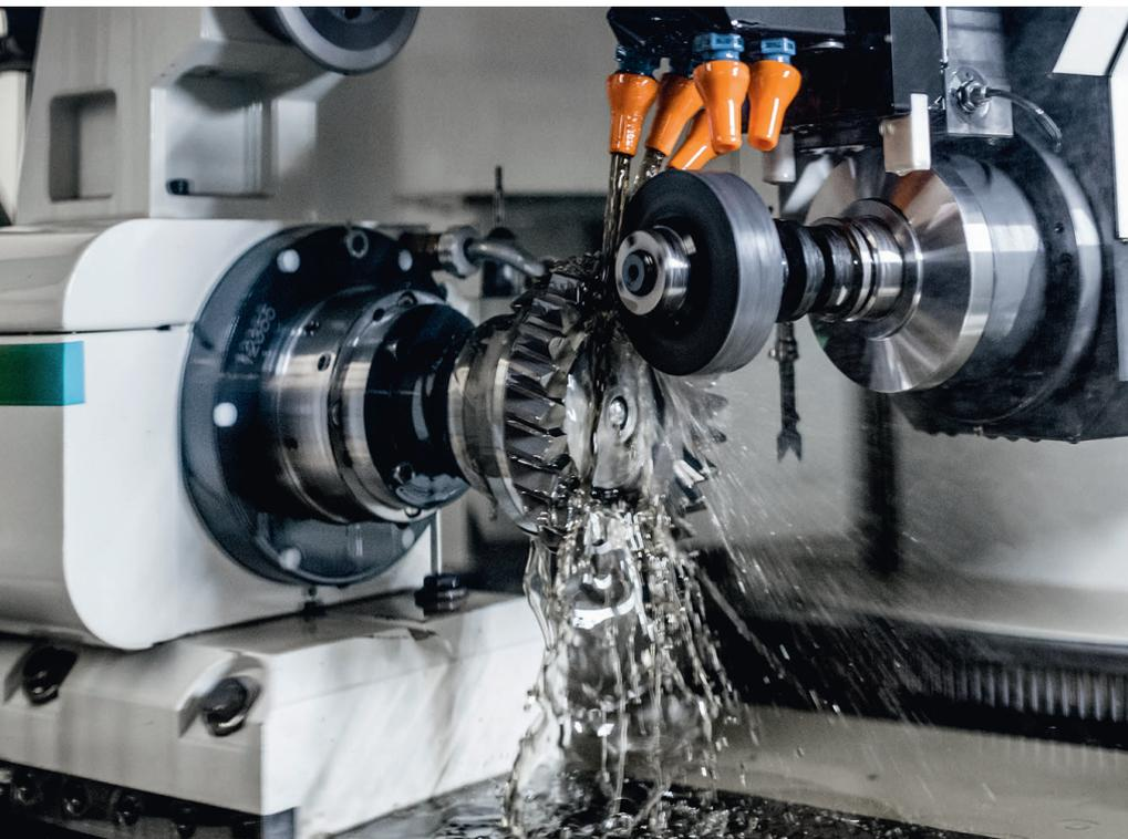
1 Zwei Gründe für den ›Siegeszug‹ des Wälzschälens sind die hohe Produktivität und die große geometrische Flexibilität beim Erzeugen von Innen- und Außenverzahnungen © PWS
